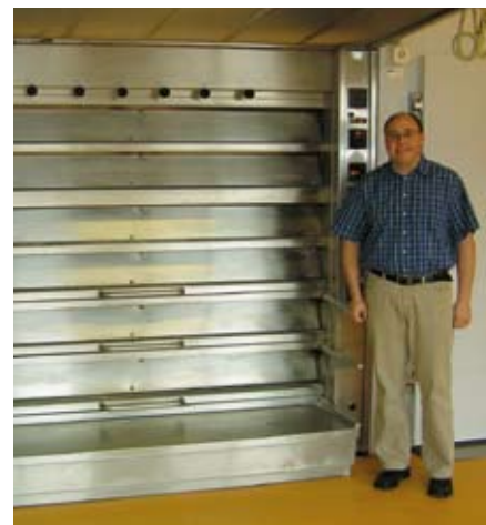
Remo Wüst vor dem grossen Backofen, bei dem das Thermoöl durch Erdgas erhitzt wird.
